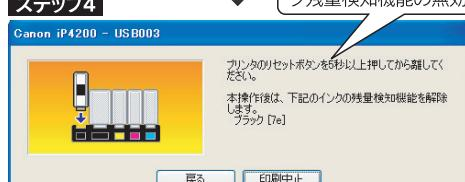
プリンタのリセットボタンを5秒以上押してから離しますと、このウインドウが閉じ、印刷が開始されます。これでインク残量検知機能の無効操作は終了です。
